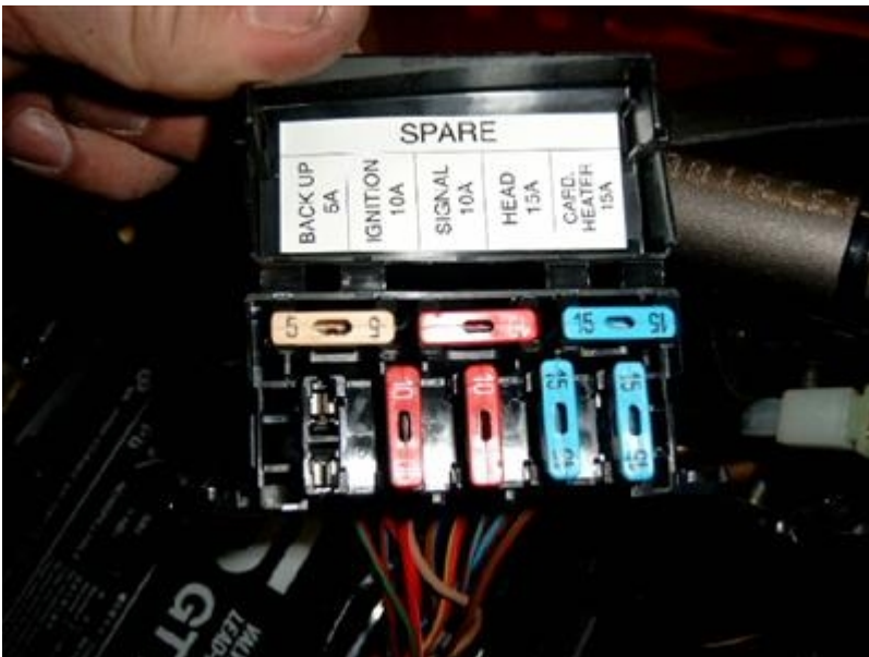
Bild 03 Die Sicherung ist weg, (Dauerplus für Tacho)
